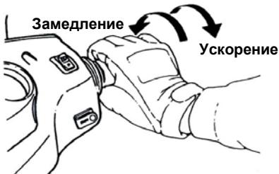
Ускорение: Увеличение скорости. При движении под гору медленно поворачивайте ручку газа до сцепления двигателя с ходовой частью.
