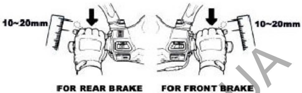
Регулировка тормоза барабанного типа.
