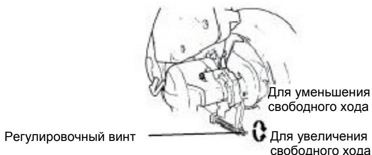
Задний тормоз барабанного типа
