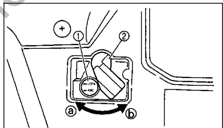
на панели приборов загораются индикаторы «DIFF.LOCK» и «
