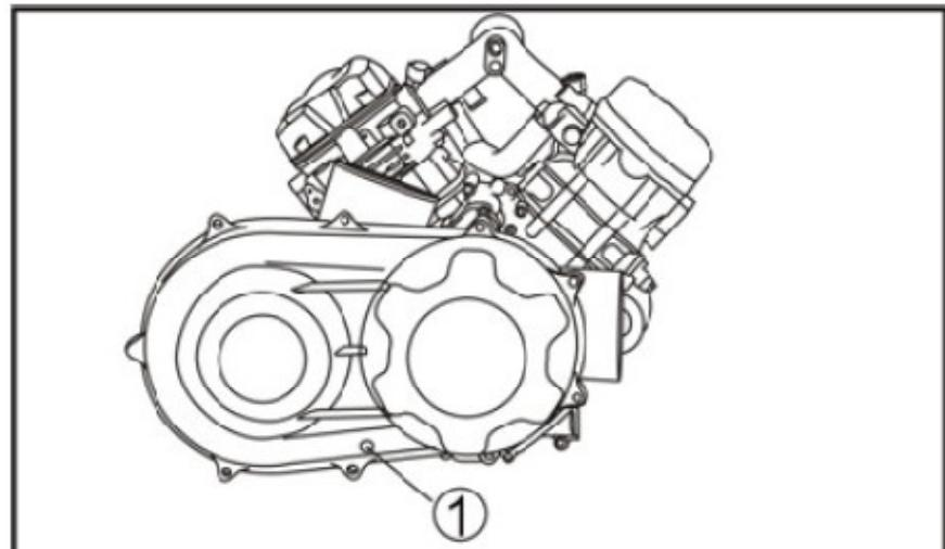
**1. Сливная пробка корпуса вариатора**
